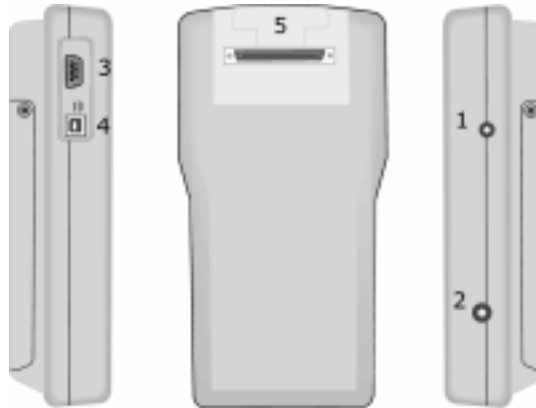
Abbildung 2-3: Schnittstellenanschlüsse des Display-Handgeräts
